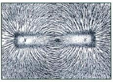
Magnetische Feldlinien in der Umgebung eines Stabmagneten, sichtbar gemacht mit Eisenfeilspänen auf Papier
